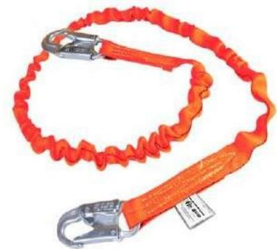
La Línea de Vida CABEL protege a una altura mínima corta de 5.40 m. Elaborada con ganchos de seguridad y amortiguador de caídas. Está elaborada en poliéster, ganchos de seguridad tipo carabinero y amortiguador de caídas.
